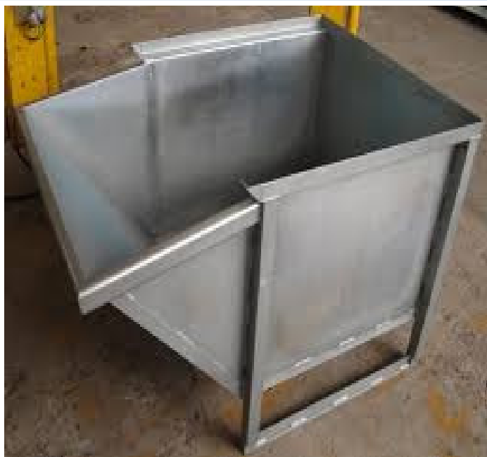
Figura 3: Caçamba para descarte de piso
